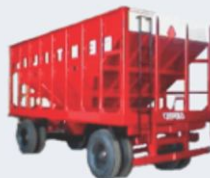
Acoplado para semilla y fertilizante. Capacidad de carga de 14 m 3
